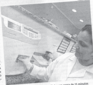
Equipamento faz a contagem das células em cerca de 15 minutos
